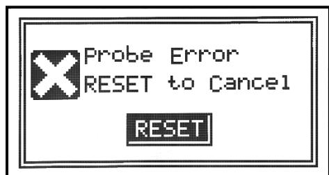
La sonde n'est pas connectée ou présente un dysfonctionnement, la vérifier et appuyer sur ENTER pour réinitialiser.
