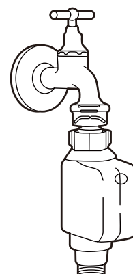
tuyau d'arrivée d'eau de sécurité
